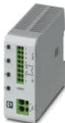
Многоканальный электронный автоматический выключатель, в комплекте, для защиты четырех потребителей сети 24 В пост. тока от перегрузки или короткого замыкания. С электронной блокировкой настроенных номинальных токов. Для установки на DIN-рейки.
