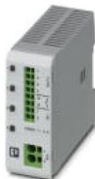
Многоканальный электронный автоматический выключатель для защиты четырех потребителей сети 24 В пост. тока при перегрузке или коротком замыкании. С электронной блокировкой настроенных номинальных токов. Для установки на несущих DIN-рейках.
